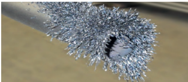
Fig. 6 Copeaux métalliques dressés sous forme de sapin indiquant la présence de magnétisme
