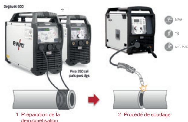
Fig. 7 Démagnétisation avant le soudage
