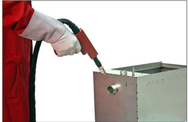
**Bild 7** Heften mit spotArc-Punktschweißbrenner
